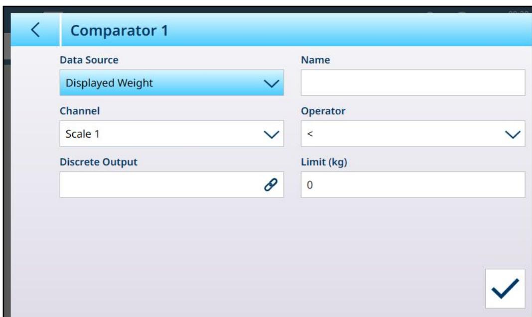
Fig. 40: Écran de modification du comparateur par défaut - Source de poids
