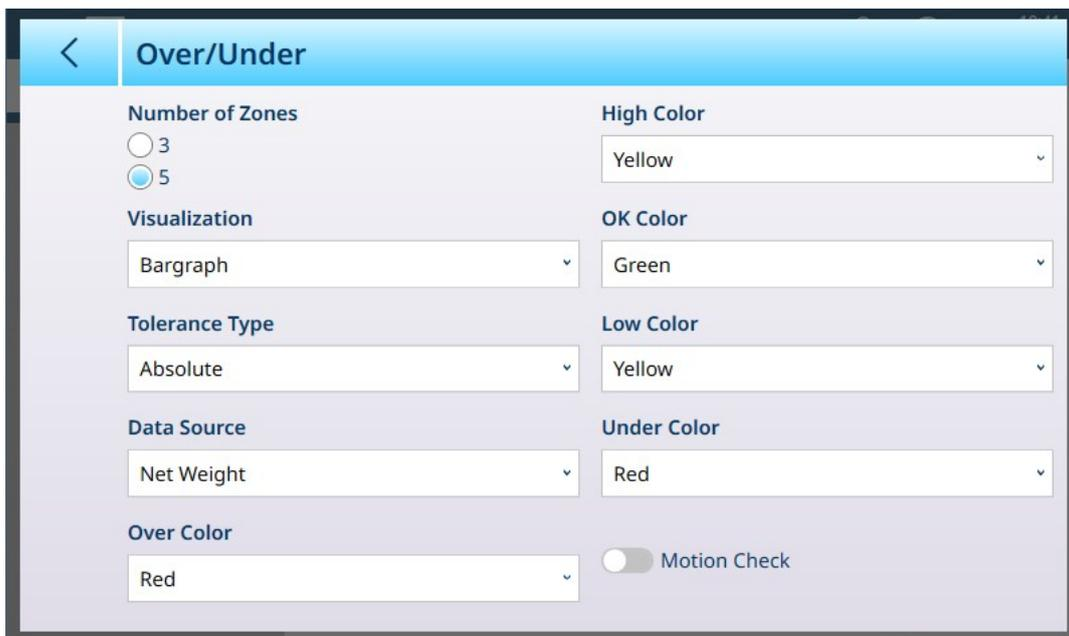
Fig. 111: Pesage cible - Écran de configuration Plus/Moins, 5 zones, visualisation sous forme d’histogramme
